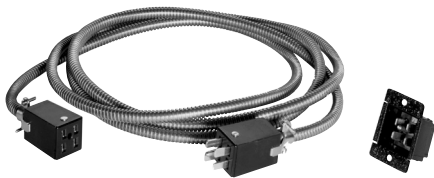
Werkzeugkabel 604-ACA für Netzstrom und Thermofühlersteuerung. 10" (25,4 cm) lang mit optionalem Anschluss für Werkzeug P15405DB. Dieses Kabel bietet Strom für eine Zone und Thermofühler, max. 15 Amp, und wird am PC-1 und PC-2 verwendet.
