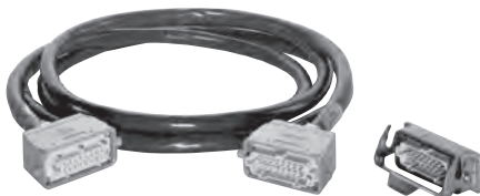
1614-CA. Werkzeugkabel für Netzstrom und Thermofühlersteuerung. 15" (38,1 cm) oder 20" (50,8 cm) lang, mit Anschluss für Werkzeug 1614-BPA. Bis zu 4 Zonen.
